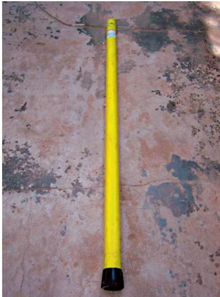
ภาพที่ 3.7 เครื่องมือวัดความสูง (Measuring Pole)
